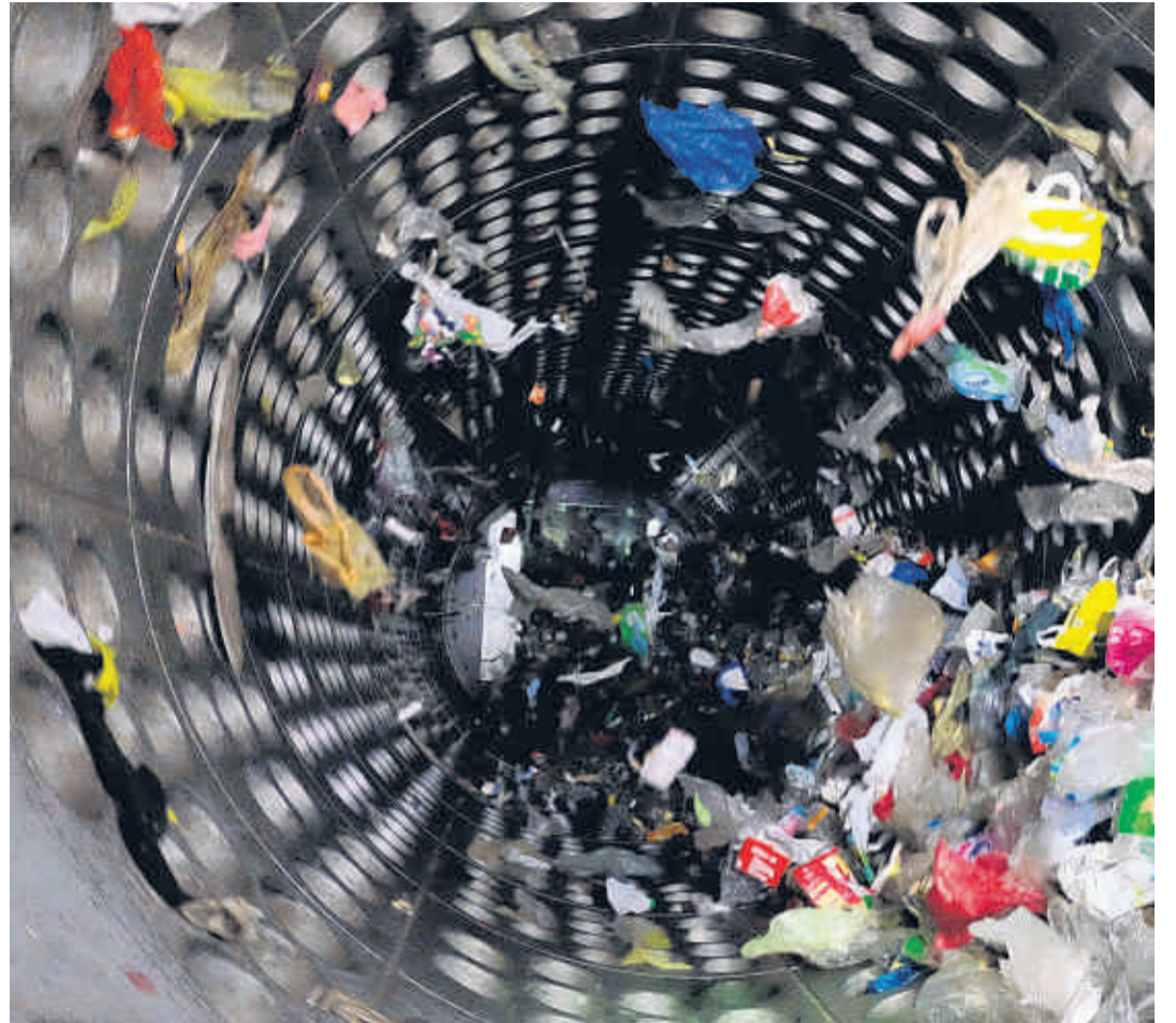
Über ein Labyrinth von Fließbändern wird der Verpackungsabfall transportiert, in diversen Trommeln gerüttelt, geschüttelt und mit Hilfe von Nah-Infrarot sortiert.
